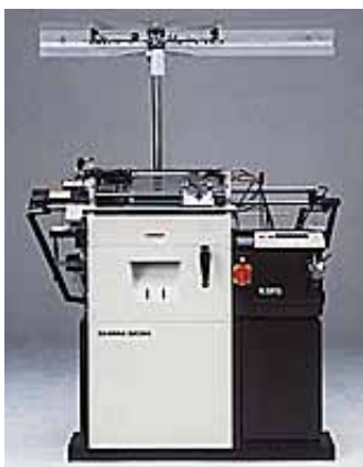
Abb. 19. Strickmaschine für Handschuhe (Shima Seiki)
